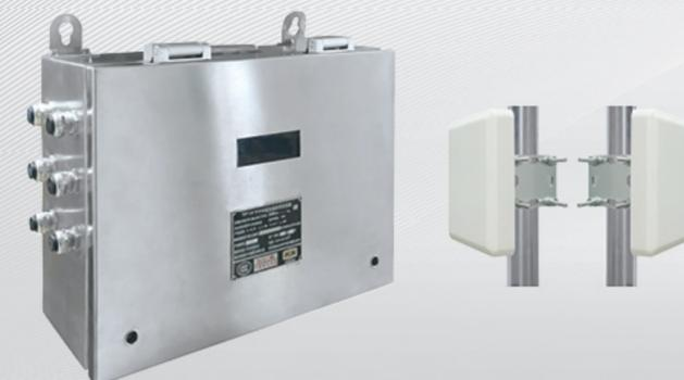
KJF12 矿用本安型基站是一款基于以太网 TCP/IP 协议的无线传输产品，具有丰富的接口，支持 485 和 CAN 总线接入，同时配置高增益的定向天线，可实现 300 米无线信号范围的覆盖，在该范围内支持同时 16 个终端的无线接入；支持 IEEE802.11/802.11b/802.11g/802.11n 通讯协议。
