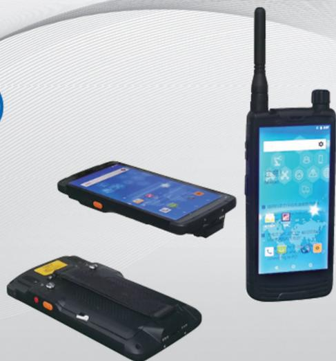
KJD3.7 矿用本安型手持终端是一款基于 Android 系统的煤矿专用手机，可兼容目前各种 Android 版本的 APP 通讯软件，同时可借助煤矿井下的无线 WIFI 网络和局域网架构的服务器实现语音、视频、群组对讲、无线控制、视频查看以及各种设备的运行状态查看、控制等功能，KJD3.7 矿用本安型手持终端具有独立的 TDMA 无线对讲功能；是一款多用途的无线终端设备。
